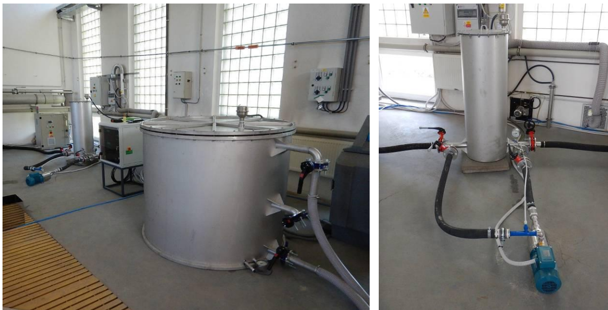
obr. 4 Celkový pohled na pilotní jednotku sonolýzy ozonu (vlevo) a systém vnosu ozonu do vody (vpravo)
