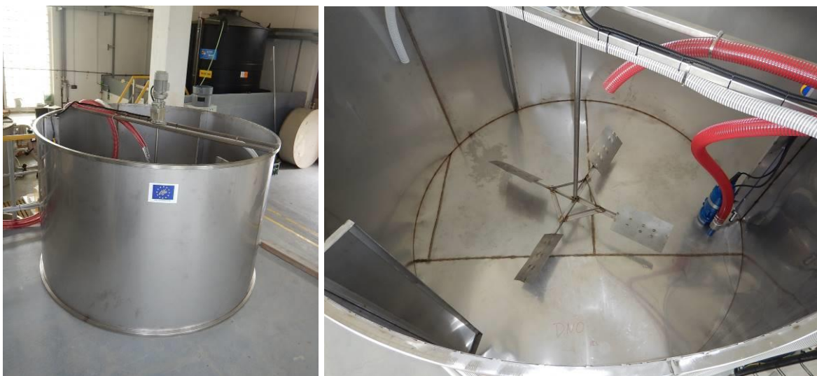
obr. 2 Reakční nádrž s míchadlem
