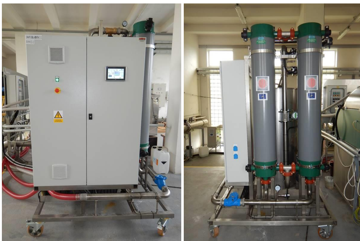
obr. 3 Rám ultrafiltrace: pohled na skříň rozvaděče (vlevo) a membránové moduly (vpravo)
